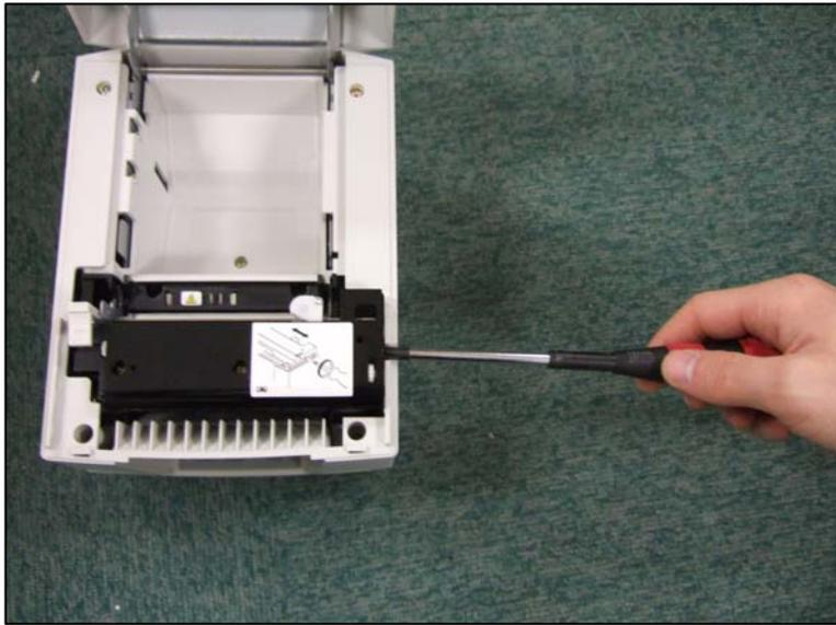
5. プラスドライバーで回すとカッターが移動します、しっかりと黒いカバーに収まる様に移動させて下さい
