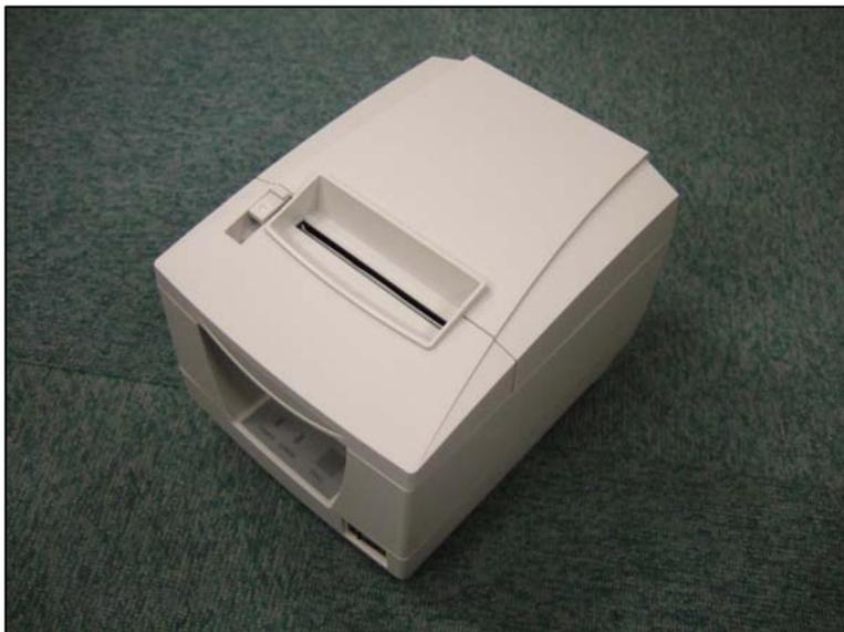
6. 前面カバーを取り付け、ロール紙を入れて蓋を閉じたら何回かテスト印刷を行って下さい。
